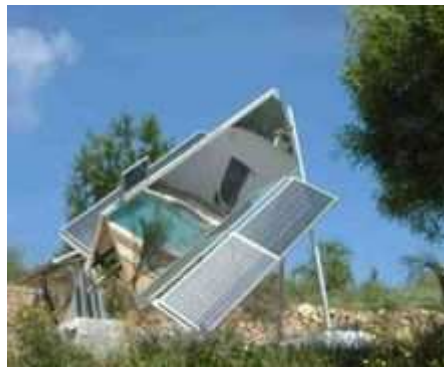
Panely s natáčením kolem jedné osy se zrcadlem - roční produkce cca 170 kWh/m 2 (156%) (produkce závisí na ploše zrcadla, je-li zrcadlo příliš velké, hrozí "spálení" článků)
