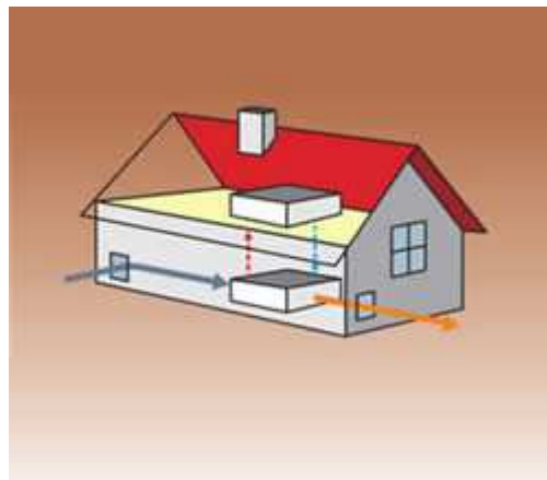
Tepelné čerpadlo vzduch/voda; ochlazuje se vzduch odváděný větracím systémem.
